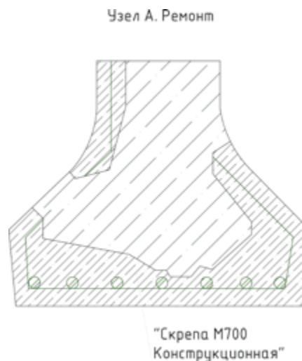
Рис. 16. Общая схема восстановления балок пролетных строений
